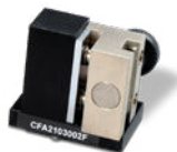
Klemmbacke für Biegesteifigkeit
